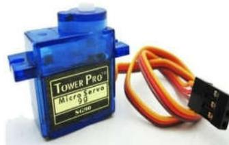
**Figure5.4. Servo motor**
